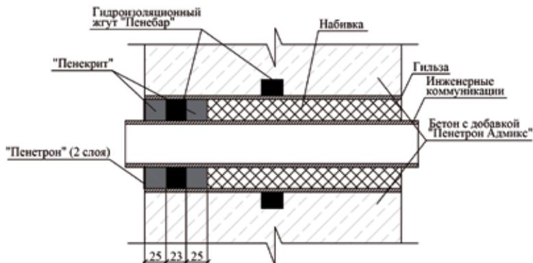
**Строящаяся конструкция****Гидроизоляция вводов инженерных коммуникаций**
