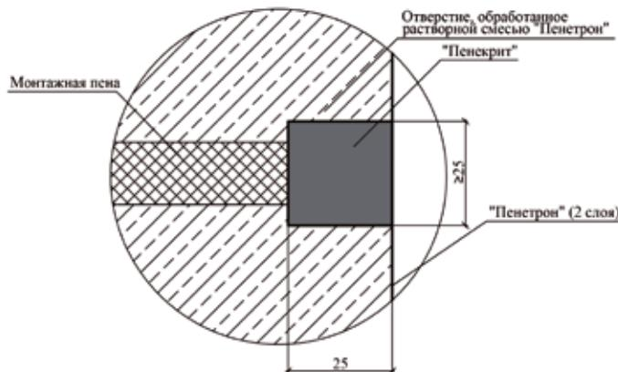
Существующая конструкцияГидроизоляция вводов инженерных коммуникаций
