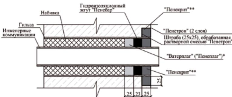
Существующая конструкцияГидроизоляция вводов инженерных коммуникаций
