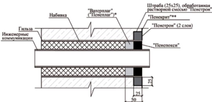
\*применяется при наличии активных течей на момент производства работ, при отсутствии течей необходимо использовать "Пенекрит".
